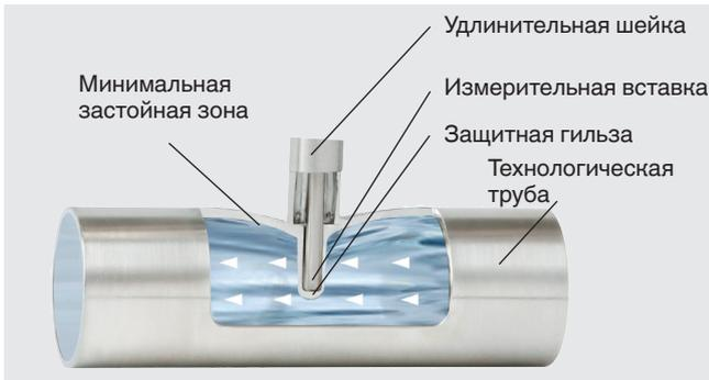
Запатентованная асептическая конструкция проточного корпуса TW61 позволяет свести к минимуму застойные зоны, выполнить инвазивные измерения температуры и за счет самодренажа легко выбрать монтажное положение.
