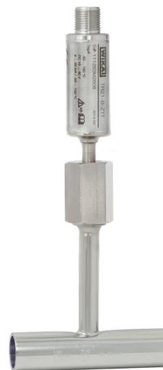
Для облегчения калибровки и проведения технического обслуживания чувствительный элемент можно заменить без вмешательства в технологический процесс, не отключая электрические соединения. Благодаря этому можно свести к минимуму опасность нарушения санитарных требований и значительно снизить время простоя.
